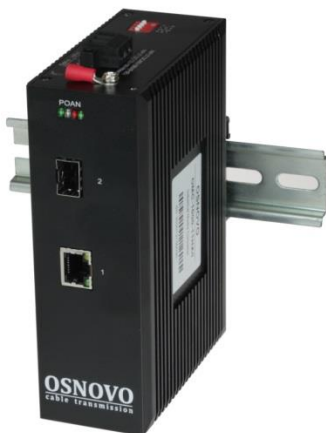
Рис.1 Медиаконвертер OMC-1000-11HX/I, общий вид
