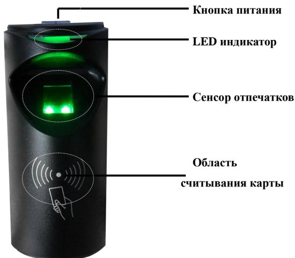
**LED индикатор:** Световой индикатор используется для отображения статусов, различных операций устройства:
