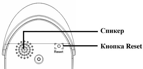
**Кнопка Reset:** Используется для перезагрузки устройства.
