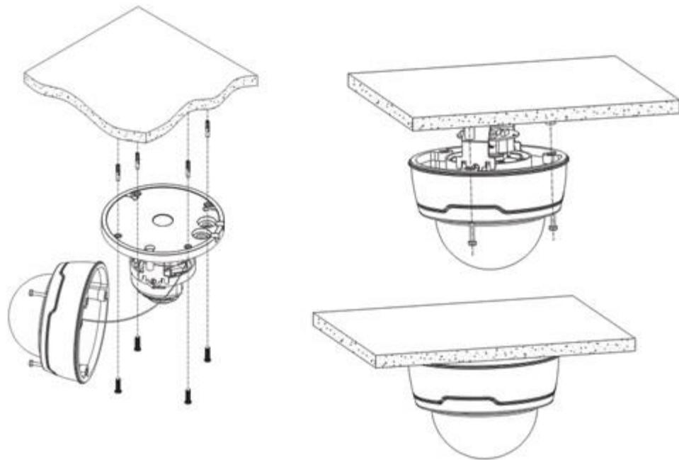
Монтаж камеры может осуществляться как на горизонтальную поверхность, так и на вертикальную. После монтажа на поверхность, настройте ракурс обзора камеры.
