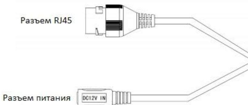
Разъем RJ45 предназначен для подключения к сети ETHERNET.
