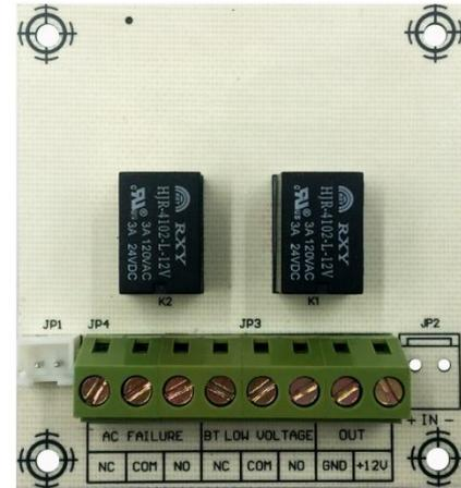
Модуль с реле мониторинга ST-PS100RB предназначен для расширения базового функционала источников питания ST-PS103, ST-PS105, ST-PS103B-BK, ST-PS103C-BK, ST-PS105C-BK, ST-PS105D-BK, ST-PS110E-BK и ST-PS110F-BK. Устройство позволяет выполнять мониторинг состояния линии 220 В и аккумуляторной батареи.
