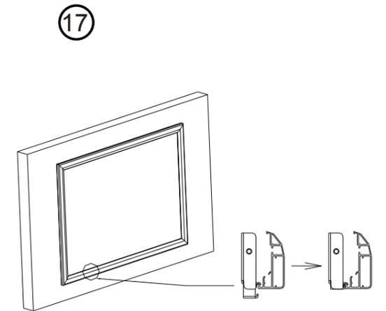
6. Затяните винты нижних кронштейнов, чтобы зафиксировать раму.
