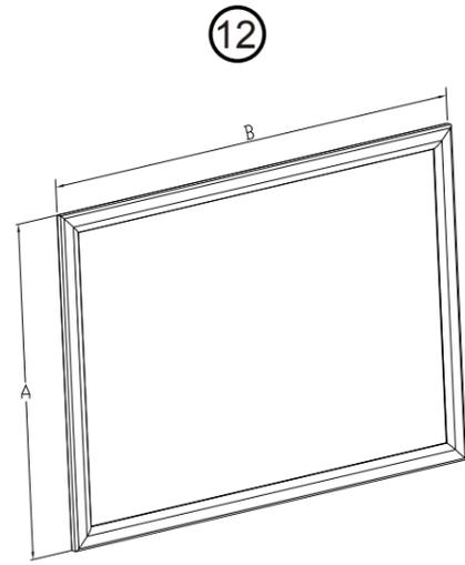
1. Измерьте ширину рамы A и высоту B
