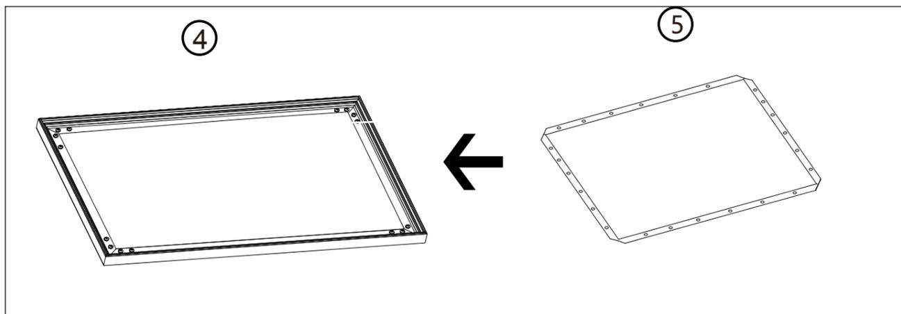
Сначала присоедините четыре угла проекционного полотна пружинами, а затем соедините остальные позиции.
