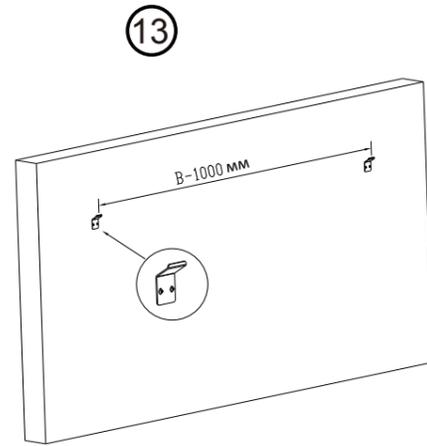
2. Прикрутите верхние кронштейны к стене, расстояние между двумя кронштейнами составляет высота рамы "B" минус 1000 мм, убедитесь, что все кронштейны прочно закреплены.
