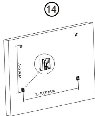
3. Прикрутите нижние кронштейны к стене, расстояние между верхним кронштейном и нижним кронштейном составляет ширина рамы "A" минус 3 мм.
