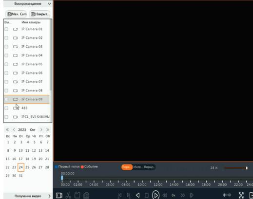
Слева находится календарь и видеокамеры. Вы можете выбрать определенную видеокамеру и дату просмотра архива. Внизу экрана видеорегистратора находится шкала записи (зеленая и желтая). Присутствует стандартная панель управления видеофайлами.
