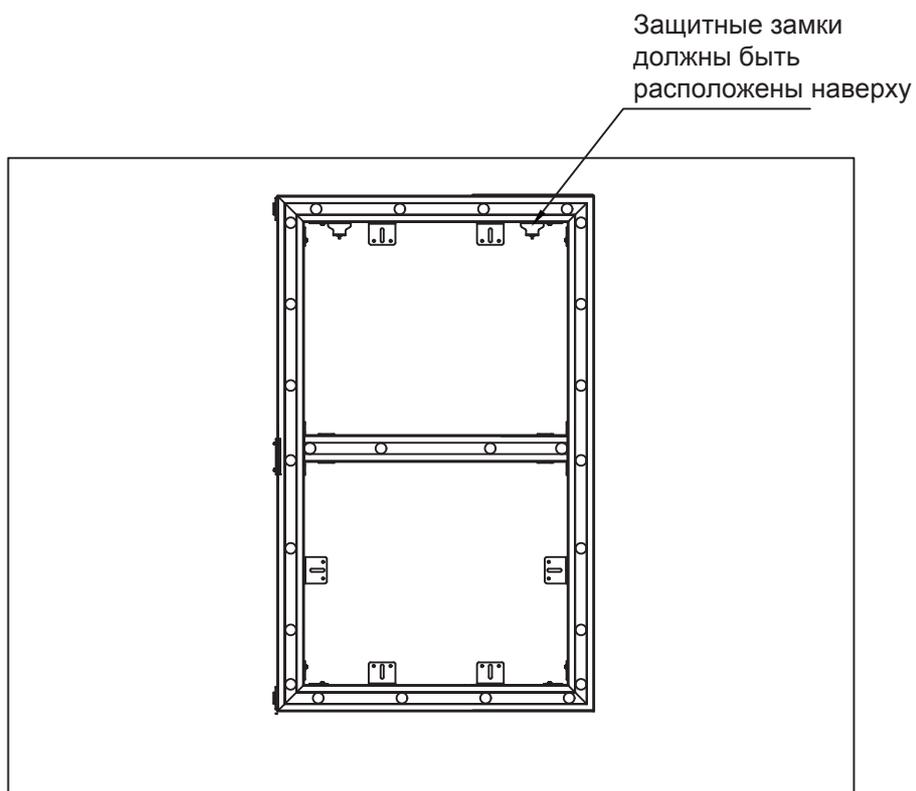
7. Отрегулируйте положение рамы по вертикали и горизонтали, используя отверстия на монтажных кронштейнах.
