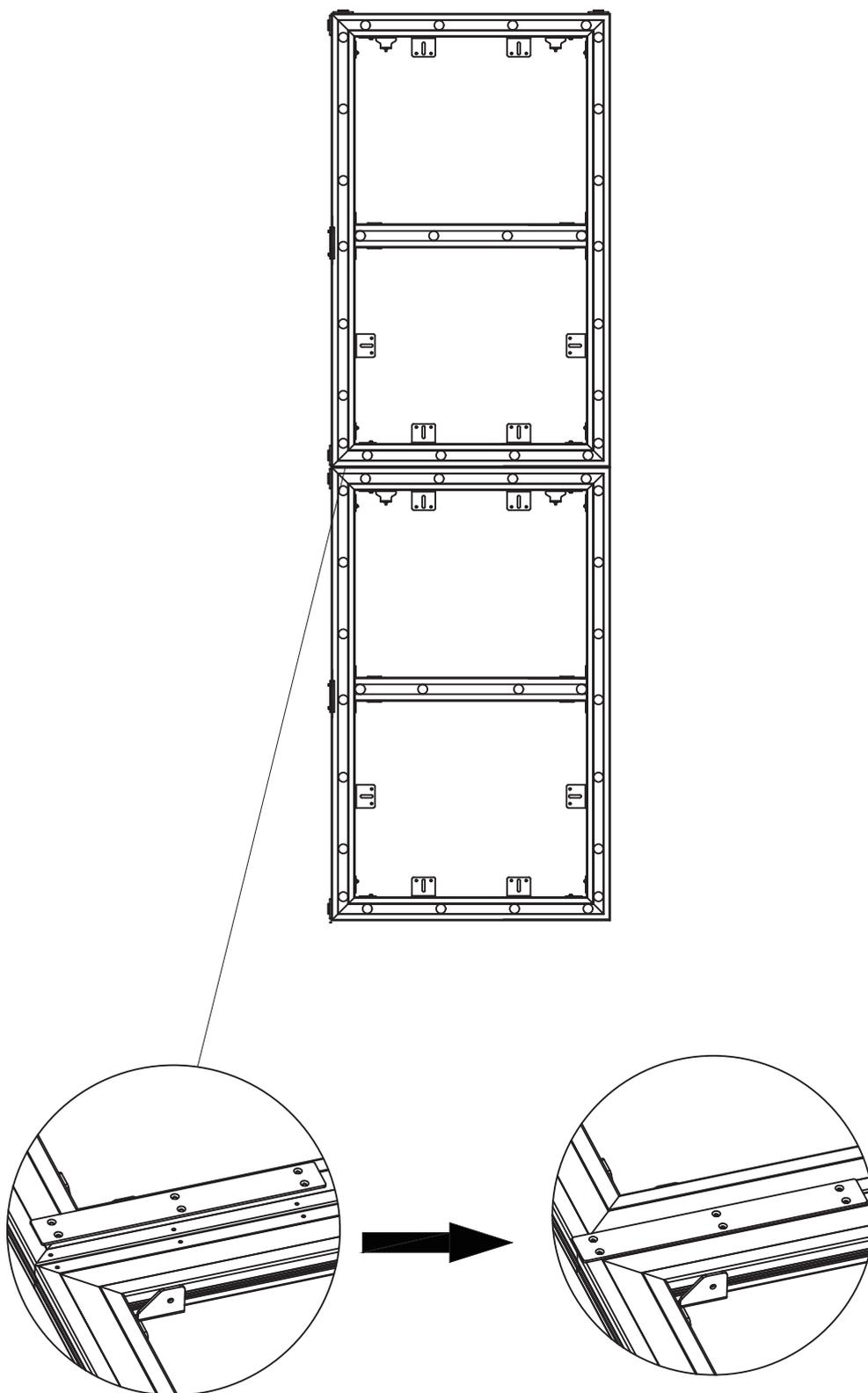
9. Установите регулировочный кронштейн и боковой декоративный магнит, предварительно сдвинув Т-образные гайки в подходящее положение.
