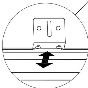
2. Ослабьте винты, чтобы отрегулировать раму вперед и назад до тех пор, пока она не примет вертикальное положение.
