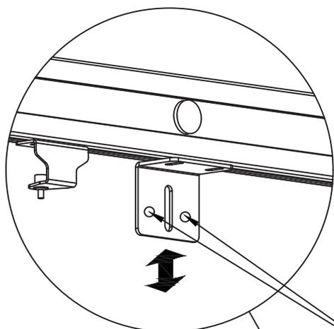
1. Ослабьте винты, чтобы отрегулировать раму вверх и вниз до тех пор, пока она не примет горизонтальное положение, затем затяните винты после регулировки.
