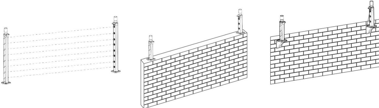
Перед монтажом убедитесь в правильности выбранной позиции, затем сделайте разметку и просверлите отверстия для установки анкеров, в заключение вставьте в просверленные отверстия анкеры и затяните их.
