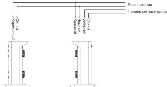
**Подключение нескольких детекторов для увеличения размеров перекрываемой зоны**, параллельное подключение линии питания, последовательное подключение тревожных выходов НЗ, ОБЩ.
