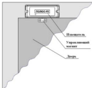
Рис. 3 Размещение на двери без металлических конструкций
