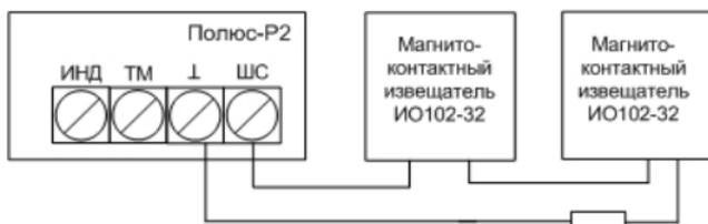
Рис. 1 Схема подключения внешних извещателей
