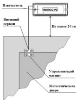
Рис. 4 Размещение на металлической двери
