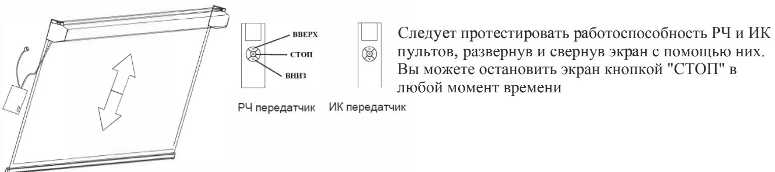
**1. ИК управление.** Дистанционный пульт управления должен быть в прямой видимости с приемником сигнала. Дальность действия сигнала - 4,5 м.
