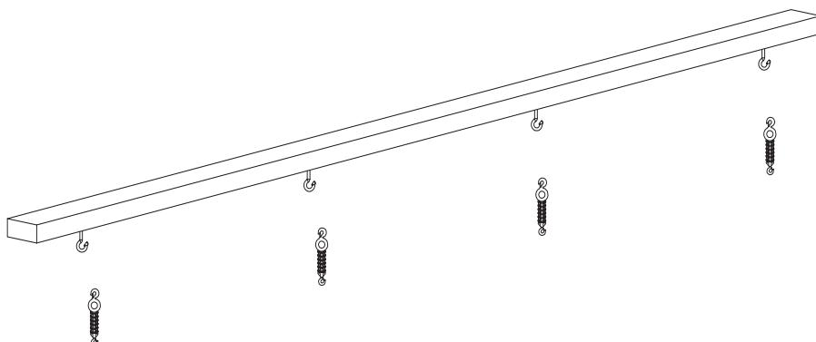
1. Замерьте расстояние между подвесными кольцами на корпусе экрана и расположите монтажные крюки на потолке на тех же расстояниях друг от друга. Пристегните цепные лебедки (или цепи) к крюкам на потолке. Расчетная нагрузка на каждый крюк должна быть не менее 200 кг.
