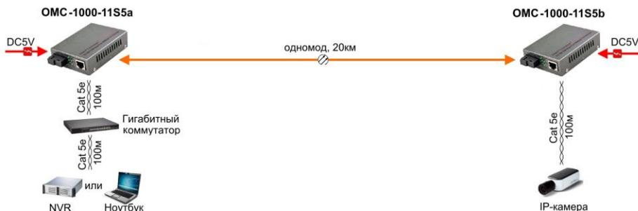
Рис. 4 Схема подключения медиаконвертеров OMC-1000-11S5a и OMC-1000-11S5b
