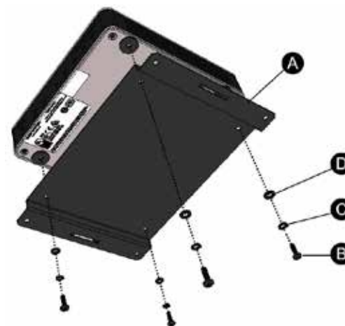
Рис. 1. Установка монтажного кронштейна
