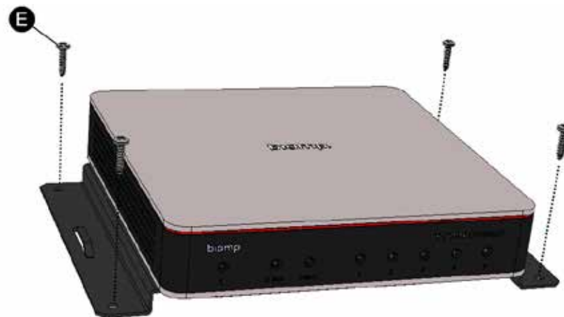
Рис. 2. Установка устройства TesiraCONNECT
